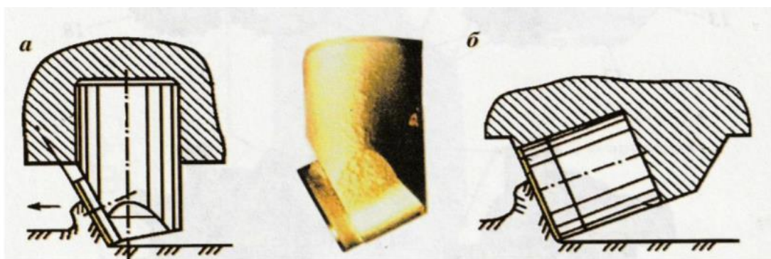
1.5 Сурет – алмаз-карбидті тіс (а) пен алмаз-карбидті кескіш (б)
